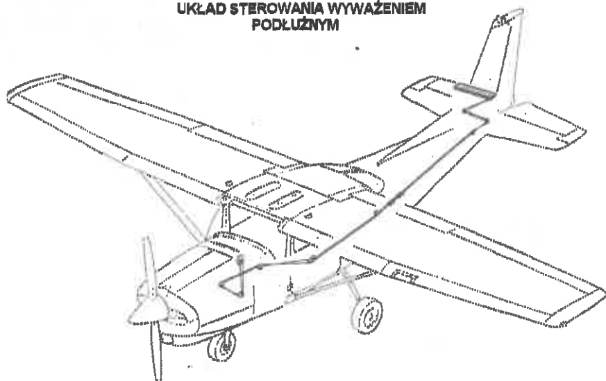
Rys. 7-1. Układy sterowania samolotem i wyważania (arkusz 2 z 2)
