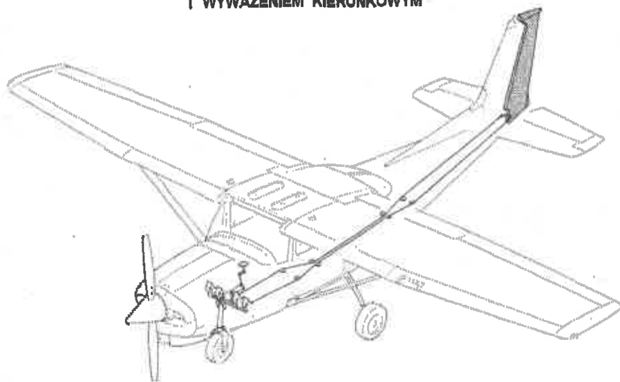
Rys. 7-1. Układy sterowania samolotem i wyważania (arkusz 1 z 2)
